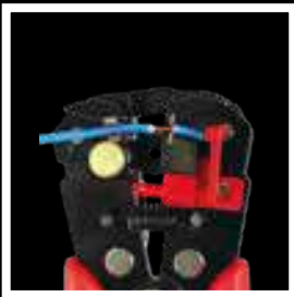
Skidanje izolacije Wire stripping
