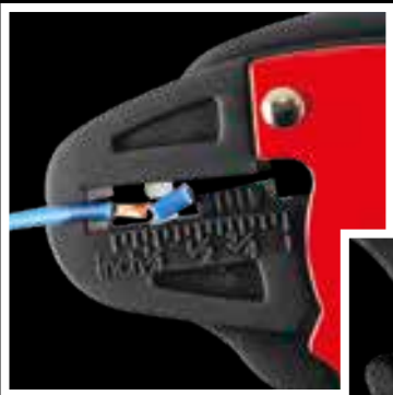
Skidanje izolacije Wire stripping
